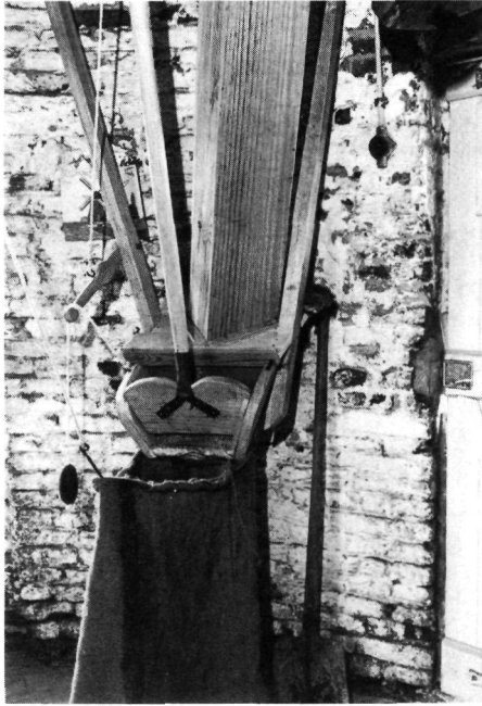
Afb. 83. meelpijp met toebehoren in bergmolen De Welvaart te Horn
